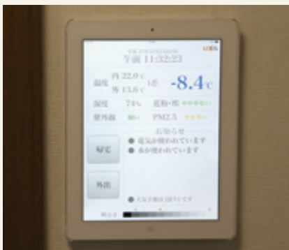
玄関に設置されたモニター。家の内と外の温度差や紫外線の量などを表示するほか、電気の消し忘れなども知らせる
